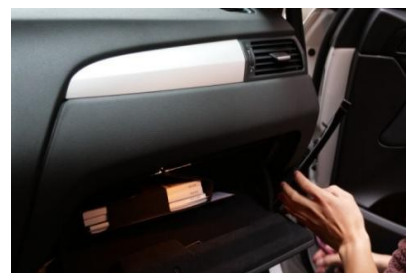
27. Entfernen Sie die Beifahrerseitenverkleidung
