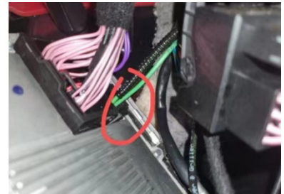
24. Stecken Sie das Radioanschlusskabel ein
