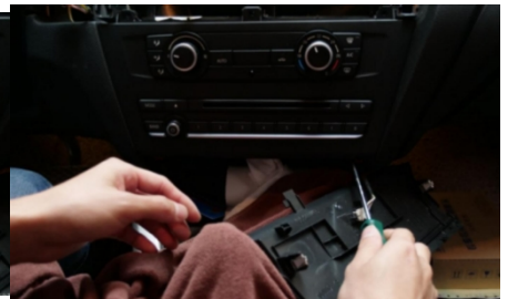
12. Entfernen Sie die Schraube
