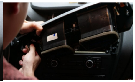
3. Entfernen Sie die Verkleidung der Klimaanlageauslassöffnung
