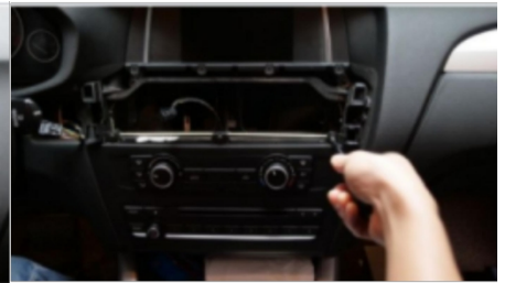
6. Schrauben Sie die Schraube ab
