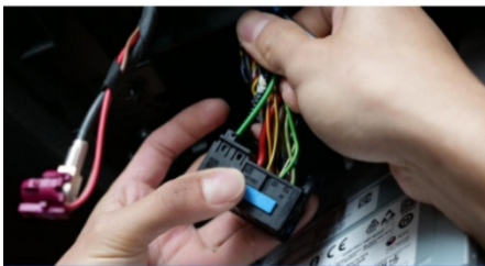
22. Entnehmen Sie die Glasfaser aus dem Originalfahrzeug und installieren Sie sie am modifizierten Kabelbaum
