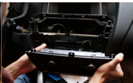
14. Entfernen Sie das Radio
