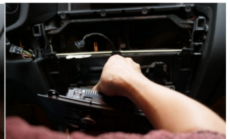
15. Entfernen Sie das Radio
