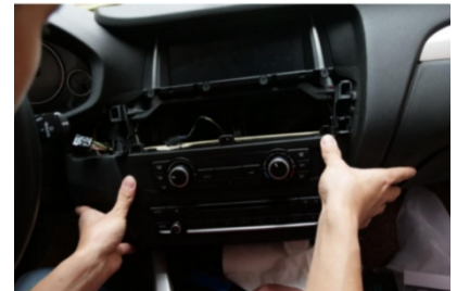
39. Ersetzen des Radios
