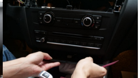
9. Entfernen Sie die Klimaanlageabdeckung
