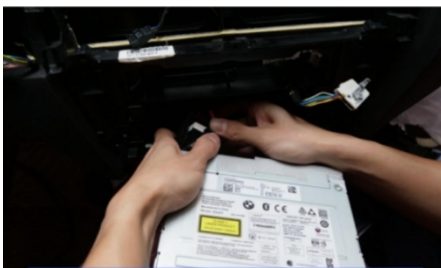
34. Nachdem der Kabelbaum in Reihe geschaltet wurde, kann der Bildschirm wiederhergestellt werden
