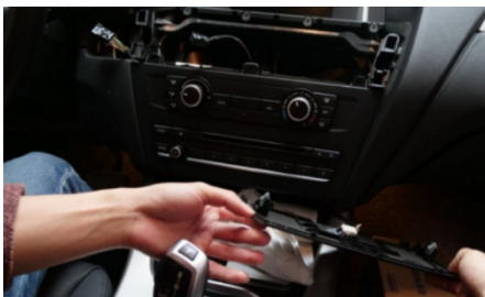
10. Entfernen Sie die Klimaanlageabdeckung. 11. Entfernen Sie die Schraube.
