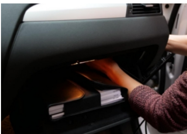
28. Entfernen Sie die Beifahrerseitenverkleidung
