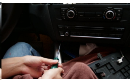
10. Entfernen Sie die Klimaanlageabdeckung. 11. Entfernen Sie die Schraube.
