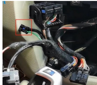
23. Entnehmen Sie das Glasfaserkabel
