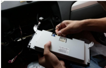
34. Nachdem der Kabelbaum in Reihe geschaltet wurde, kann der Bildschirm wiederhergestellt werden
