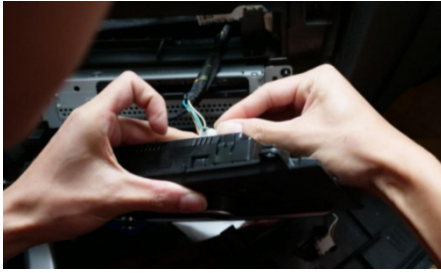
14. Entfernen Sie das Radio
