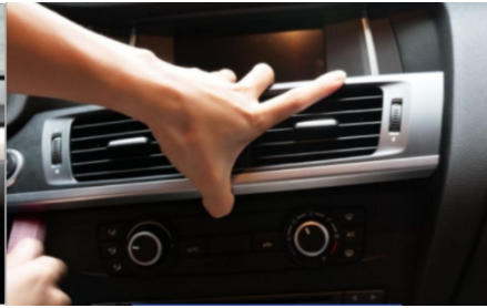
2. Entfernen Sie die Verkleidung des Klimaanlageauslasses
