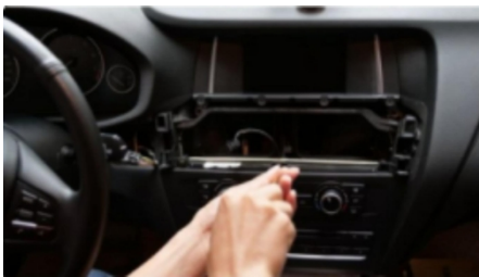
7. Schrauben Sie die Schraube ab
